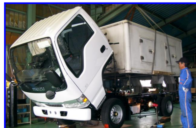
写真はコンテナの載せ換え作業中です。 クレーンで吊り上げ載せ換えます。
